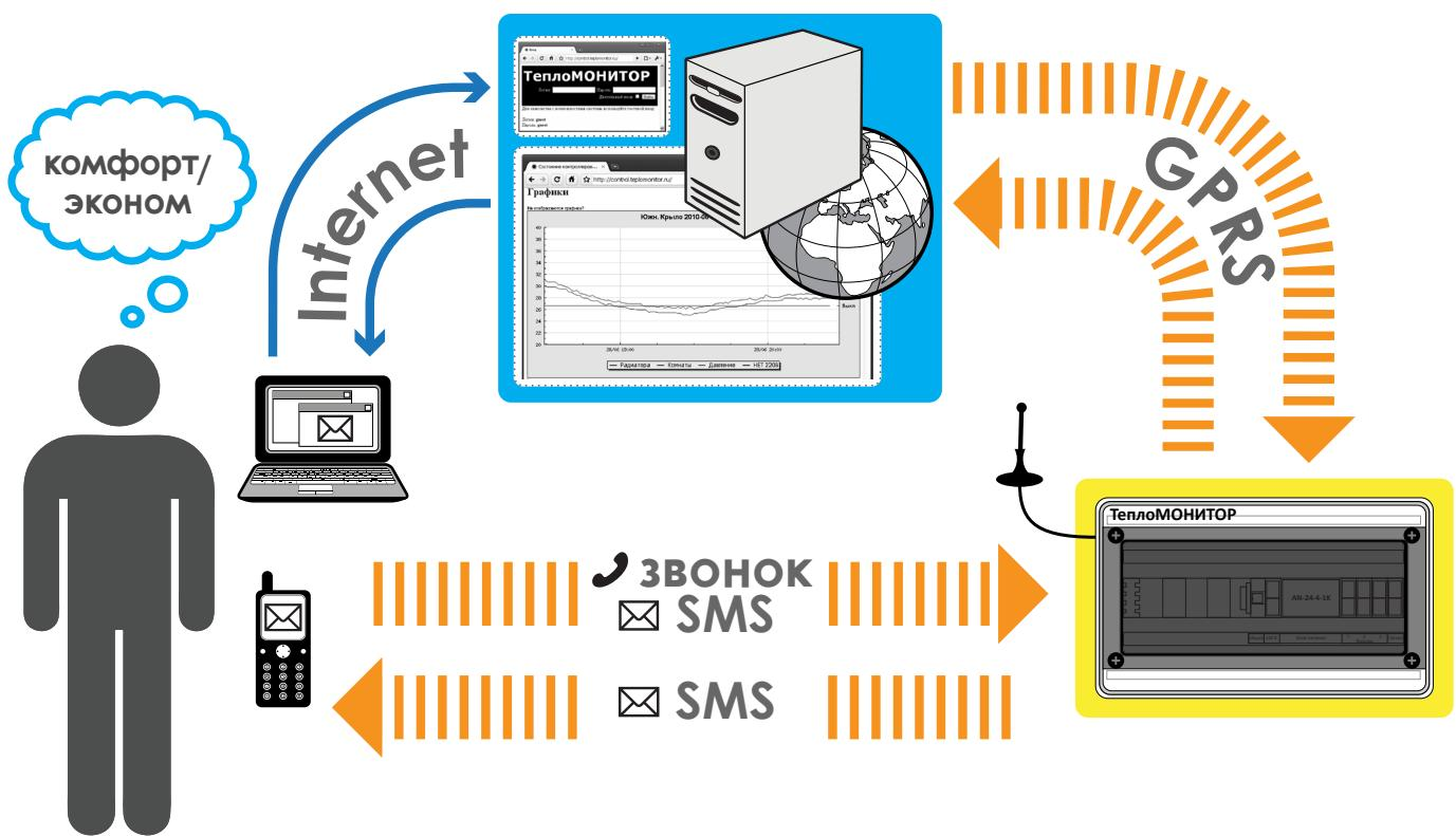
Сервер *teplomonitor* принимает информацию от контроллеров «ТеплоМОНИТОР» и сохраняет ее для последующего просмотра пользователями. Каждый пользователь имеет свою учетную запись на данном сайте и видит данные только своих контроллеров. Кроме того, у пользователей есть возможность менять состояние режимов отопления и дискретных выходов прямо со страницы контроллера.
