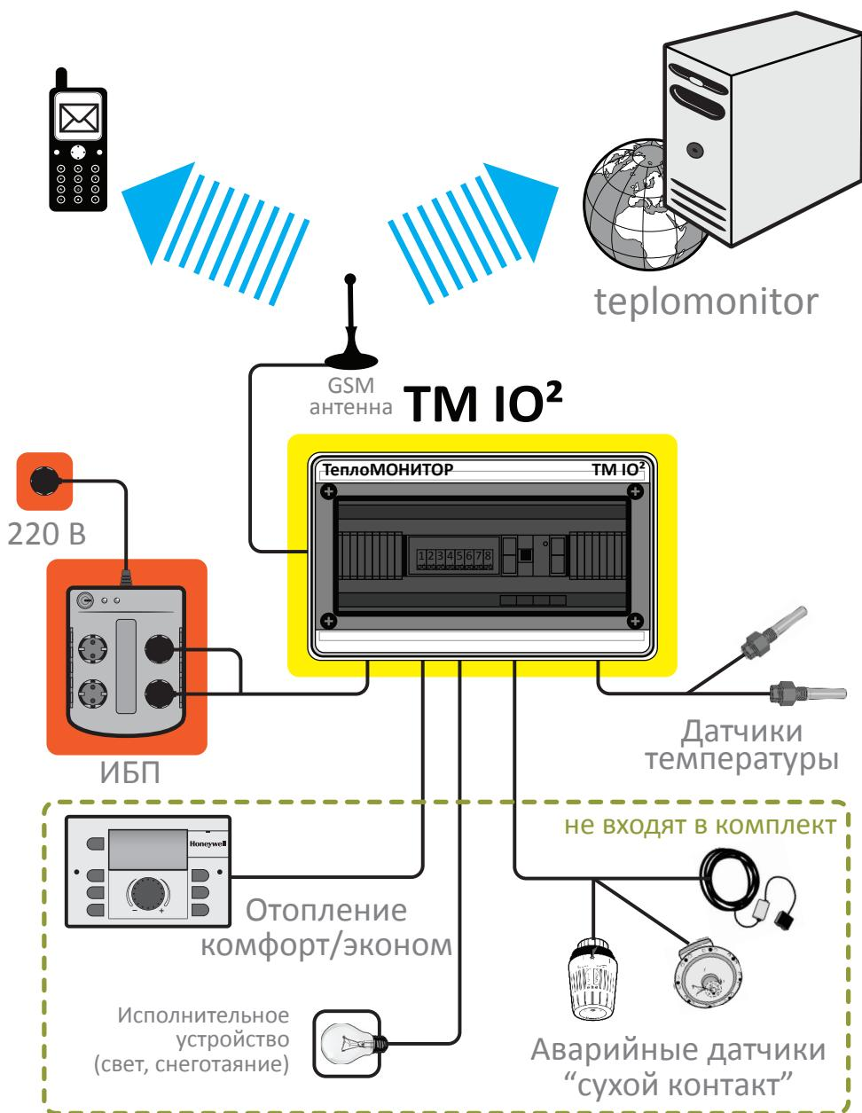
Данная аппаратно-программная система предназначена для удаленного мониторинга состояния системы отопления, а также для удаленного управления режимами отопления контроллеров KromSchroeder E8 и другими исполнительными устройствами. Система состоит из контроллера и интернет-сервера teplomonitor.
