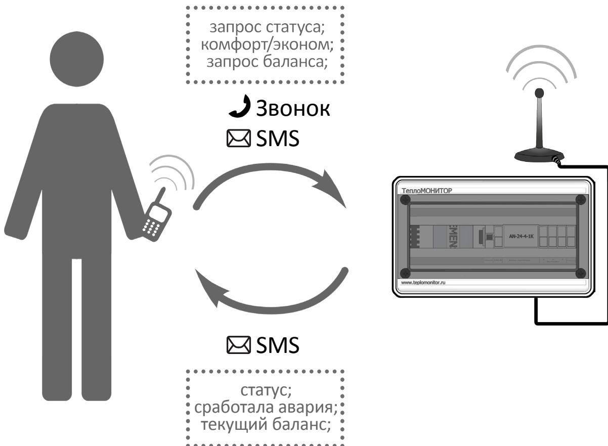
Пользователи, указанные в телефонной книге, могут при помощи SMS-сообщений переключать режимы отопления контроллеров KromSchroeder (Комфорт/Эконом), а также включать и выключать дискретные релейные выходы.
