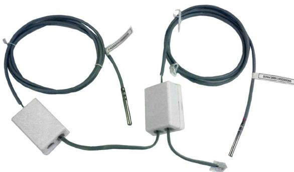
6. Датчики цифровые двухпроводные. Сажаются на общую шину из этих двух проводов, для удобства они оканчиваются телефонной розеткой с двумя выводами, что позволяет соединять их друг с другом в “гирлянду” при помощи телефонного провода, обжатого одинаково с двух сторон.
