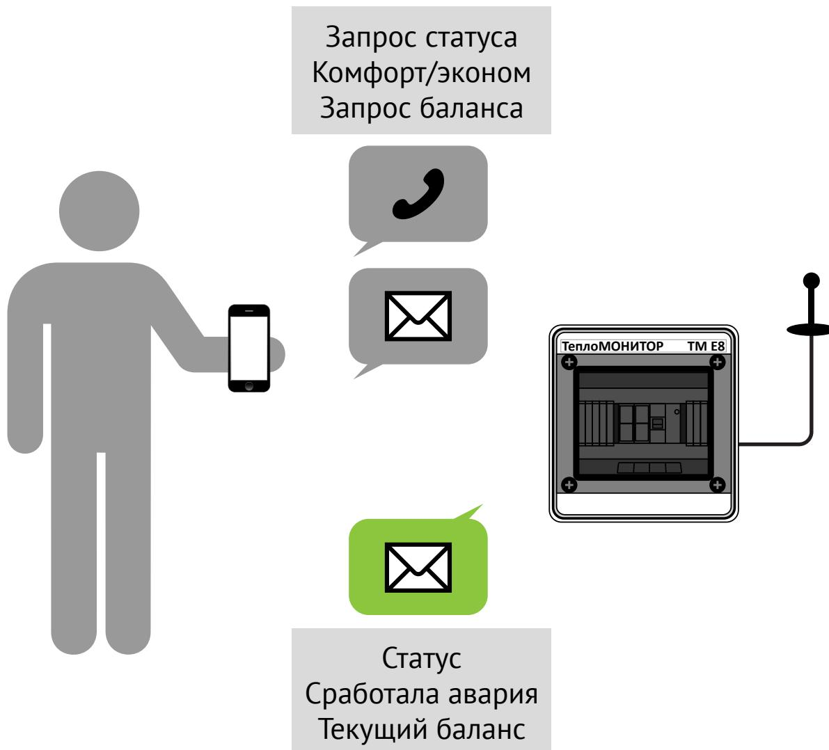
Пользователи, указанные в телефонной книге, могут при помощи SMS-сообщений переключать режимы отопления контроллеров Krom-Schroeder (Комфорт/Эконом), а также включать и выключать дискретный релейный выход.
